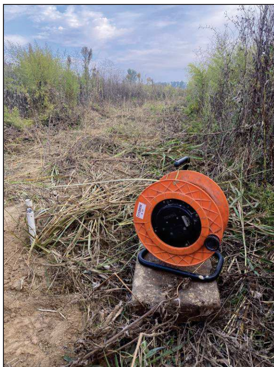
Figura 11: tubo piezometrico e rilevazione freatimetrica in corrispondenza della prova P1, comune di Vaiano Cremasco (CR), via Nelson Mandela (ATi1), il 28/09/2023
